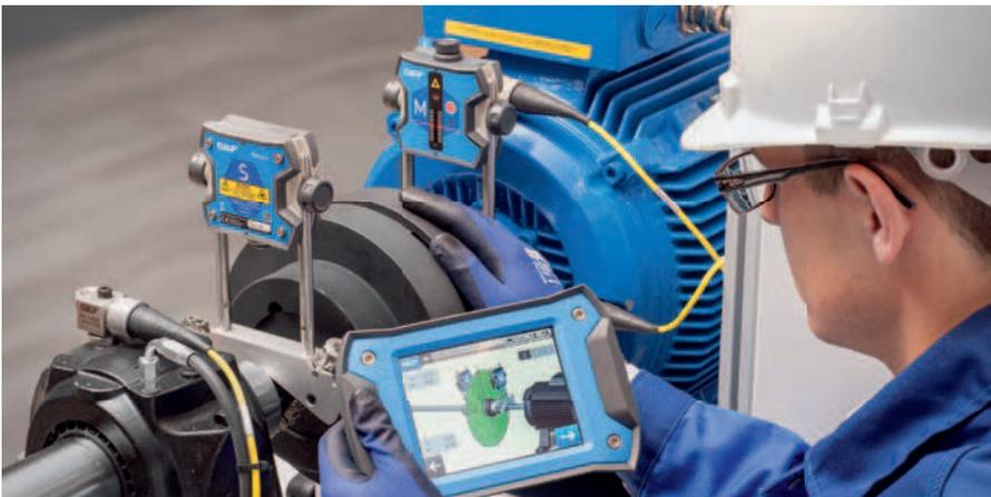
Se recomienda la alineación del eje en casi todas las industrias, ya que permite incrementar considerablemente el tiempo productivo de las máquinas y reducir los costos de mantenimiento. La simplicidad del TKSA 41 aporta mayor confianza a la hora de realizar las tareas de alineación en todo tipo de máquinas giratorias horizontales.
